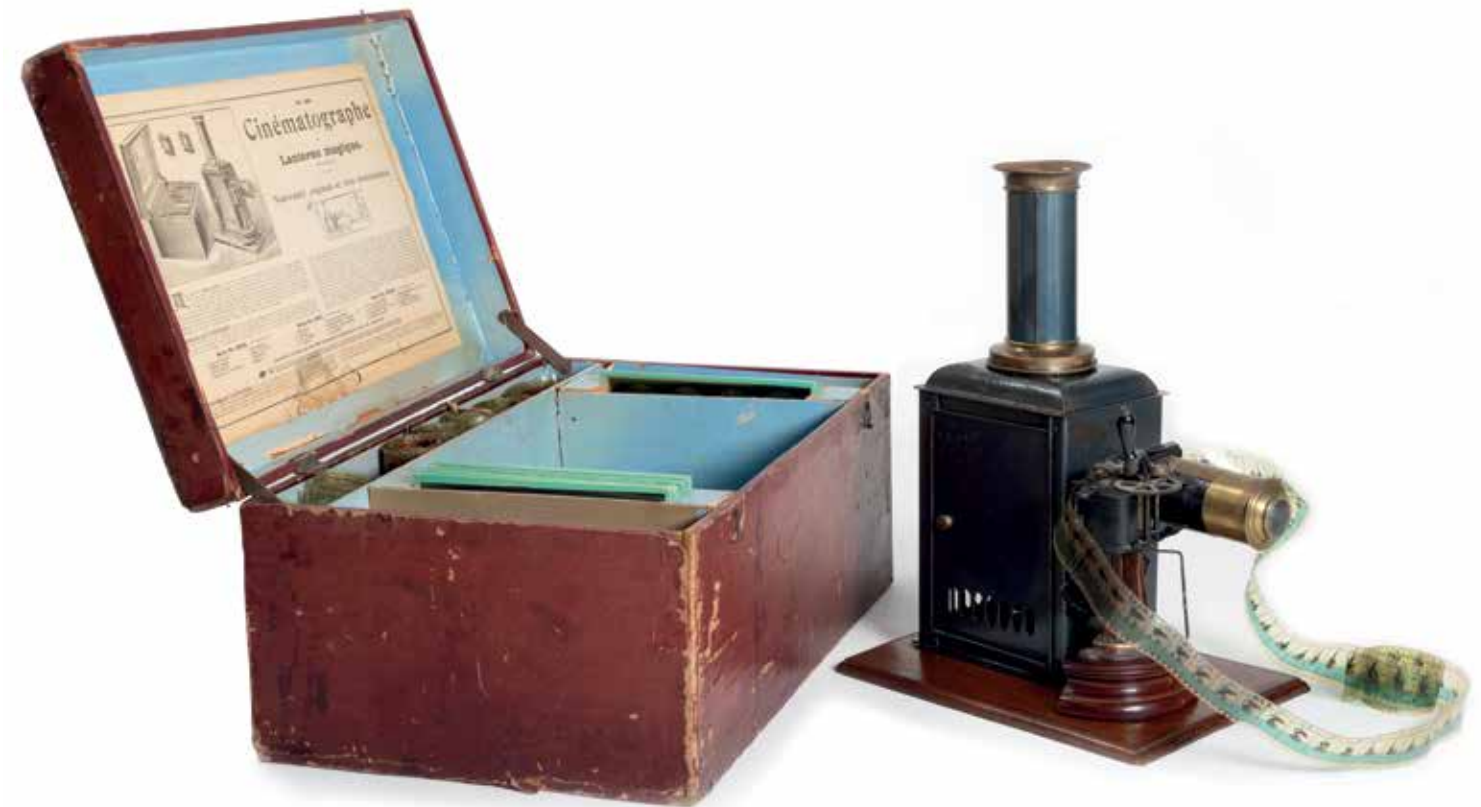
Spielzeug Kinematograph und Laterna Magica mit der originalen Kiste und Ausstattung. Ausführung für das Pariser Kaufhaus „Au Bon Marché“ Optische-mechanische Warenfabrik Georges Carette & Co., Nürnberg um 1899 Laterna magica & Kinematograph. Gehäuse aus russischem Blaublech, Holzsockel. Kinematograph für 35 mm horizontalem Film und Laterna magica für 50 mm Glasbilder.
