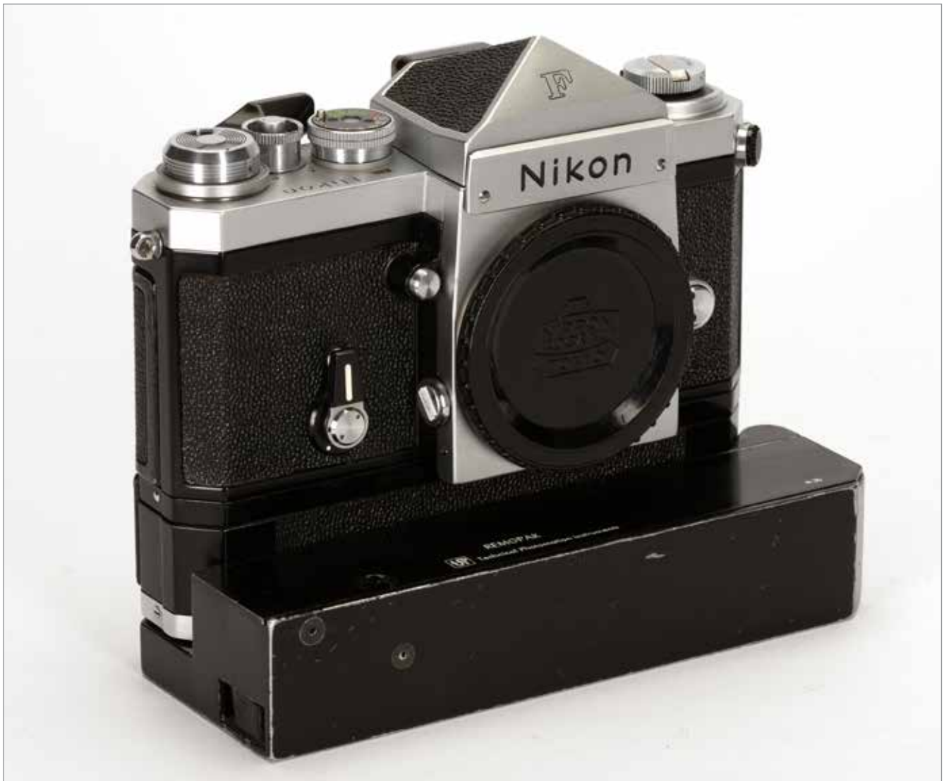
Nikon F (in der sogenannten Apollo-Ausführung) mit Prisma und Motorantrieb F 36 (1959) und einem Remopak (1965) des US-Herstellers tpi (Technical Photomation Instruments), das mit 8 AA-Batterien ausgestattet ist.
