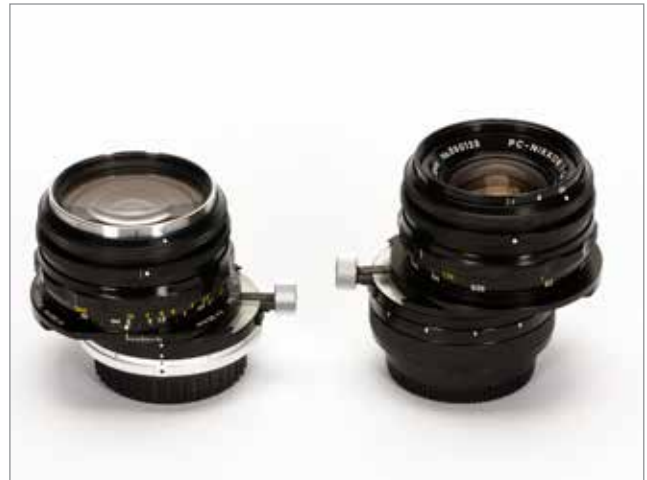
PC-NIKKOR 35mm f/3,5 (1962) – mittels eine Schraube konnte das Frontlinsenpaar um 11mm seitlich verstell und das Ganze in 30° Schritten gedreht werden. Damit ließen sich stürzende Linien zumindest bedingt vermeiden. Beim PC-NIKKOR 35mm f/2,8 (1968) – auch hier die gleiche Anwendung, nur ist das Objektiv etwas lichtstärker. Da die Blendeneinstellung in vorderen Bereich des Objektivs verbaut ist, erfolgte keine Übertragung der Blendeneinstellung auf den Belichtungsmesser der Kamera.
