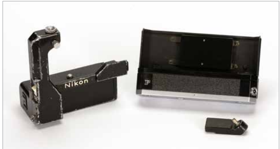
Nikon F 36 Motorantrieb (1959). Die Rückwand der Kamera wurde gegen diese Motorrückwand ausgetauscht. Zur Stromversorgung (8 AA Zellen) diente ein Nikon Powerpack mit Anschlussstecker.
