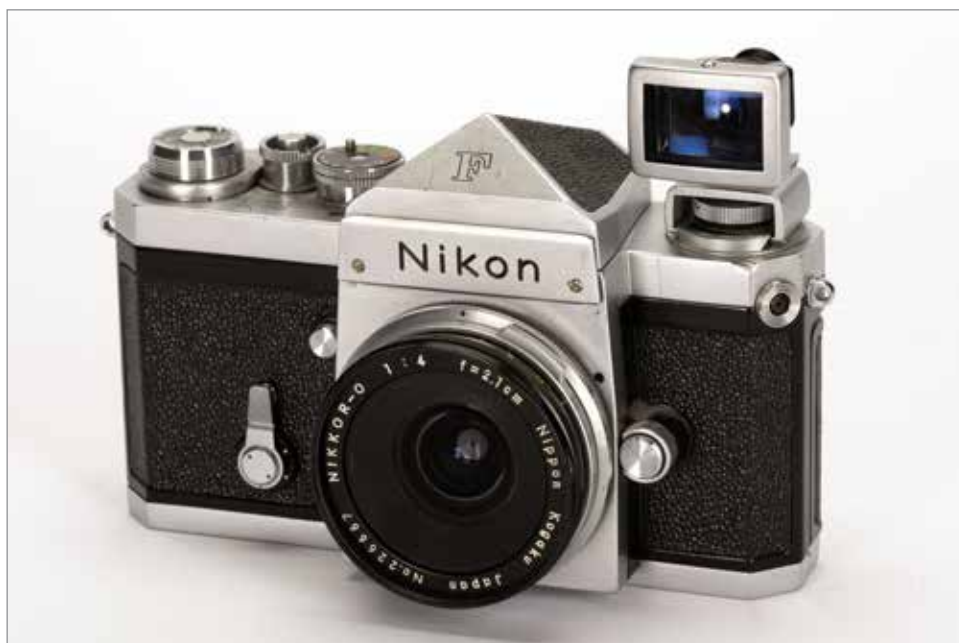
NIKKOR-O 2,1cm f/4 (1959) mit einem Bildwinkel von 92°, mit 21er Sucher. Auch hier musste der Spiegel der Kamera zum Aufsetzen und Fotografieren hochgeklappt werden.
