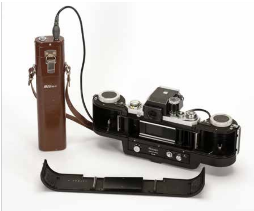
Nikon F mit Photomic FTN und Nikon Motorantrieb F 250 (1960, hier spätere Version von 1966). Die austauschbare Rückwand wird durch diese Rückwand mit Motorantrieb ersetzt. Diese Kombination ermöglicht 250 Aufnahmen zu erstellen. Die nötige Spannung des Motorantrieb erfolgt durch ein Standard-Batterieteil (1959) mit 8 C-Zellen.
