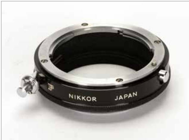
Nikkor Zwischenring E2 (1962) für Makroaufnahmen. Mit dem seitlich angebrachten Knopf konnte die Blende am Objektiv zum Scharfstellen per Hand oder mittels eines Drahtauslösers geöffnet werden.
