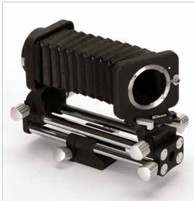
Sehr stabiles und schweres Nikon Balgengerät PB-4 (1969), bei welchem die vordere Standarte sowohl seitlich verschwenkt als auch beidseitig verschoben werden konnte. Am vorderen Schienenende konnte ein Diakopiergerät PB-4 angesetzt werden.
