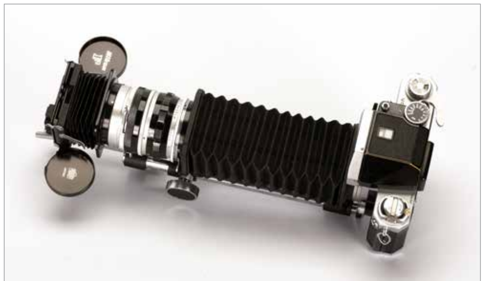
Nikon F mit Photomic FTN, Balgengerät Bellows II (1959) und Diakopiervorsatz (Slide Copying Adapter, 1959). Zur Aufnahme von Dias oder Filmen ist hier ein 2,8cm f/3,5 NIKKOR-H Auto Weitwinkelobjektiv in Retrostellung mittels des Umkehrings BR-2 und des Filteranschlussrings BR-3 eingesetzt.
