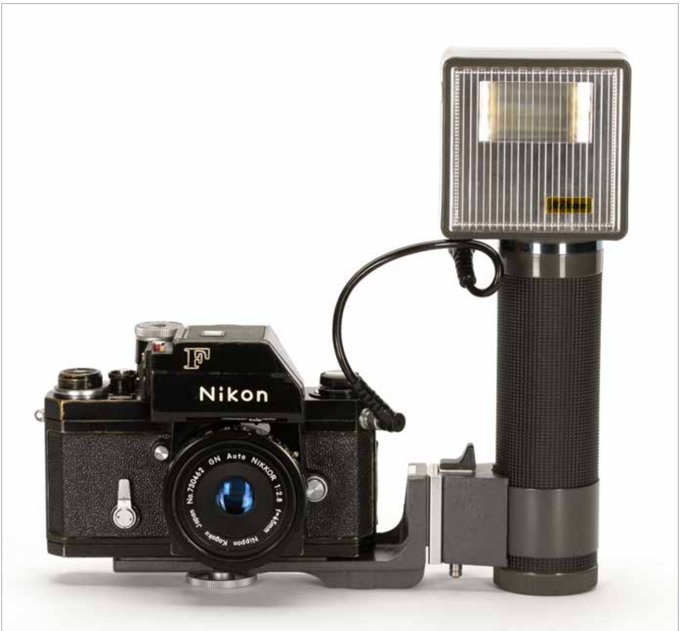
Nikon mit Photomic FTN, angesetztem GN-NIKKOR Auto 45mm f/2,8 (1968) und Blitzgerät SB-1 (1968). Am Objektiv konnte die Leitzahl und die Empfindlichkeit des verwendeten Filmmaterials eingestellt und mit der Entfernungseinstellung verriegelt werden. Entsprechend der eingestellten Entfernung wurde das Objektiv (in dem zulässigen Bereich) damit automatisch abgeblendet. Das SB-1 verfügt über einen aufladbaren Akku, dennoch konnten sowohl verschiedene Batterieteile als auch zwei Ring-Bitze angeschlossen werden.
